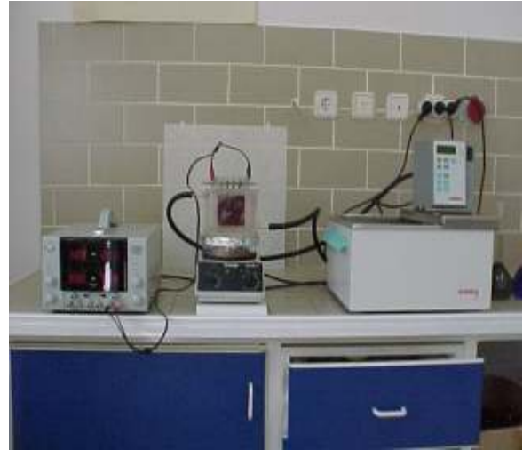
Şekil 4.2: Kesikli EC proses çalışmalarında kullanılan deney düzeneği.
