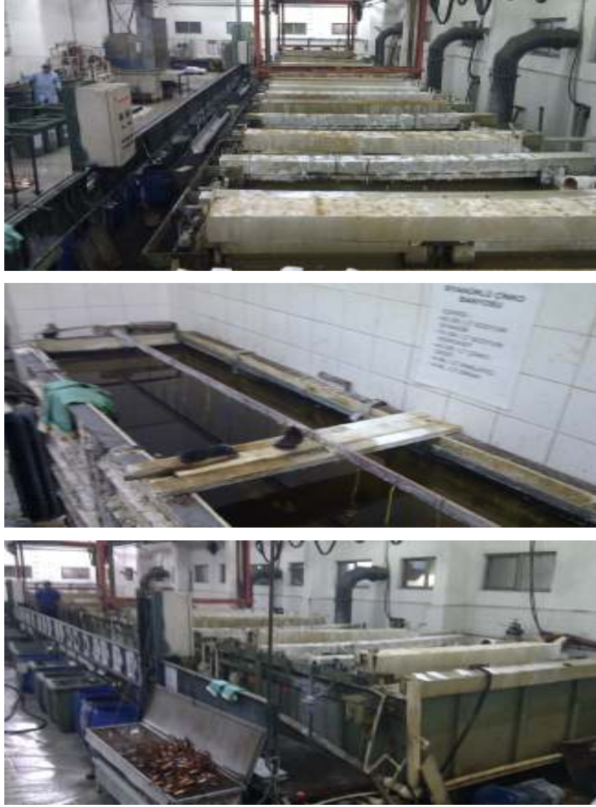
Şekil 4.1: Çinko kaplama işlemlerinden bazı görünümeler.
