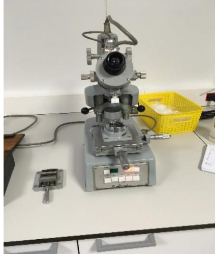
Şekil 3.11: Schimadzu Model-M vickers mikrosertlik cihazı.
