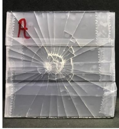
Şekil 4.2: Referans numunenin halka üstü halka testinde kırılması sonrası görüntüsü.
