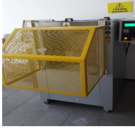
Şekil 3.1: LEMA TC 804A kimyasal temperleme fırını.
