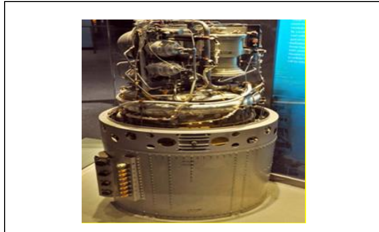
řekil 2.3: Gemini Uzay Aracında Kullanılan Proton Deęiřim Zarlı Yakıt Pili.
