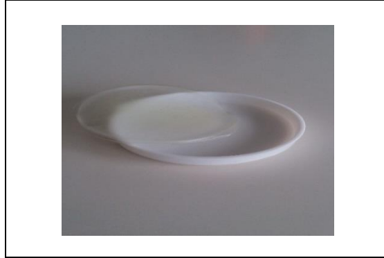
Şekil 5.1: Hekza-(4-oksi-benzensülfonik asit) siklotrifosfazen Katkılı PVT Kompozit Membran.
