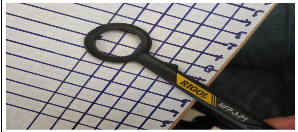
Şekil 5.6: Elektrik alan ölçümü için kullanılan NFP-3-P1 yakın alan probu.
