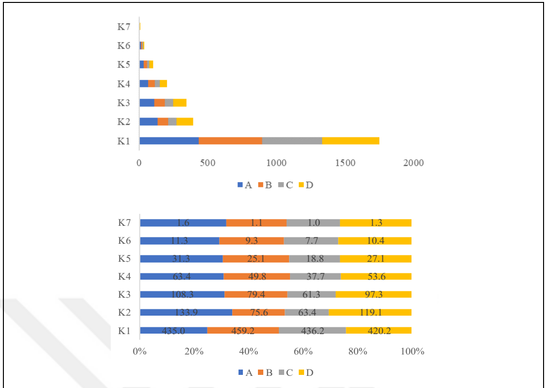
Şekil 4.40: Kat düzleminde A-B-C-D akslarındaki kolonların enerji tüketme dağılımı.
