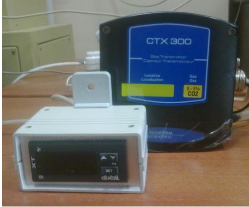
Şekil 4.11. Oldham CTX 300 CO 2 Sensörü
