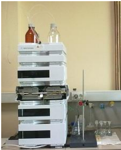
Şekil 4.16. Agilent 1200 Series HPLC Cihazı
