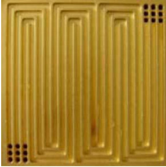
Şekil 4.3. Üçlü Paralel Serpantin Akış Kanalları
