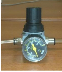
Şekil 4.9. Aignep Basınç Ayarlama Valfi
