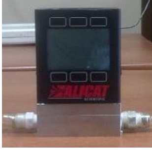
Şekil 4.10. Alicat Scientific Gaz Akışölçer
