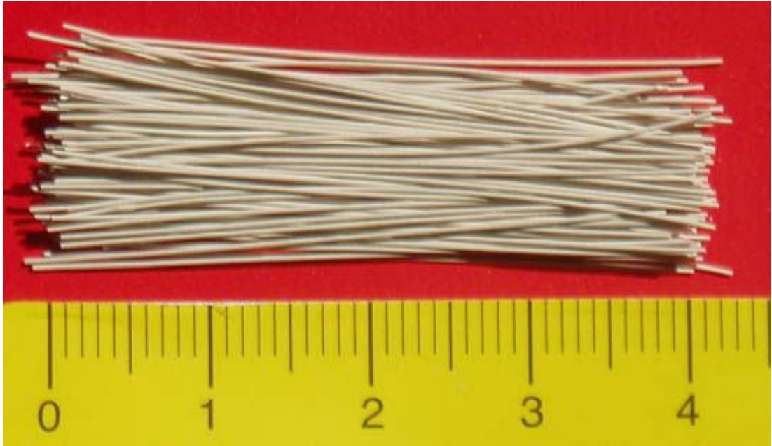
Şekil 4. 4: Sinterleme işlemi sonrası fiber görüntüsü.
