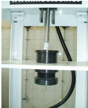
Şekil 3. 2: Makinenin asıltıyı içeren kapsül ve fiber çekilen nozül kısımlarının görüntüsü.
