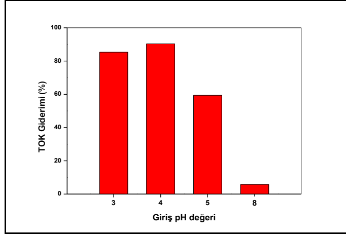
Şekil 5.24: TOK giderimi üzerine ortam pH değerinin etkisi (HDK+FF, 100 mg/L RR180, 0.25 mM Fe +2 , 2.5 mM H 2 O 2 ).
