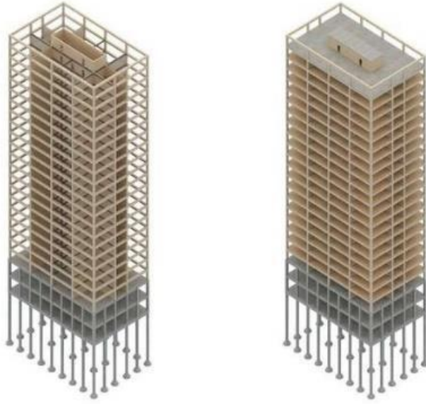
Şekil 2.14: Karkas (çerçeve) sistem [43].
