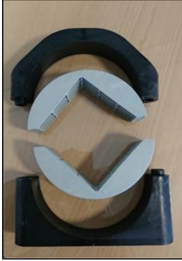
Şekil 3.5: Kullanılan yataklama sistemi-demonte hali-
