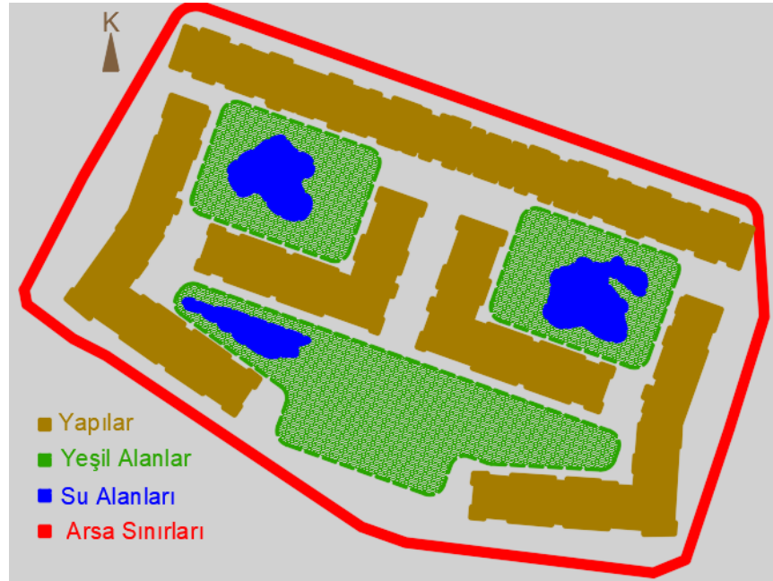
Şekil 5.40: Yerleşim Planı Üzerinde Konut Birimleri, Sosyal Donatı ve Rekreasyon Alanlarının Şematik Gösterimi.
