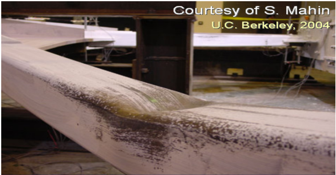
Şekil 2.13 Lokal burkulmanın gözlenmesi için yapılan deneylerden -1 [Sabelli, 2004]
