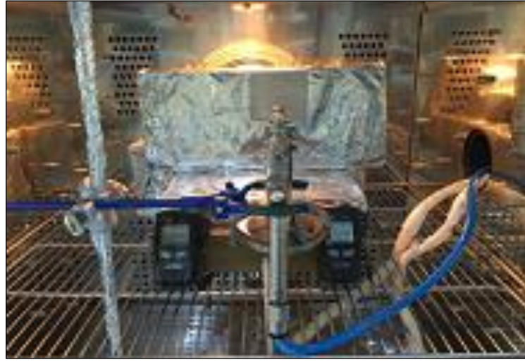
Şekil 6.14: Memmert CTC 256 model iklimlendirme kabini içinde alüminyum yüzeyde buz birikim testi.
