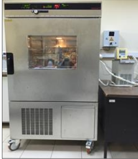
Şekil 6.11: Memmert CTC 256 model sıcaklık ve nem kontrollü iklimlendirme kabini.
