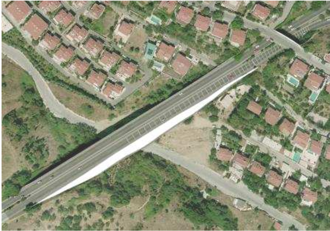
Şekil 10.7.a. Bina ve Viyadük Gibi Yapılara Ait Yükseklik Bilgileri Ortofoto Programına Girildiğinde “True Orthophoto” Elde Edilir.
