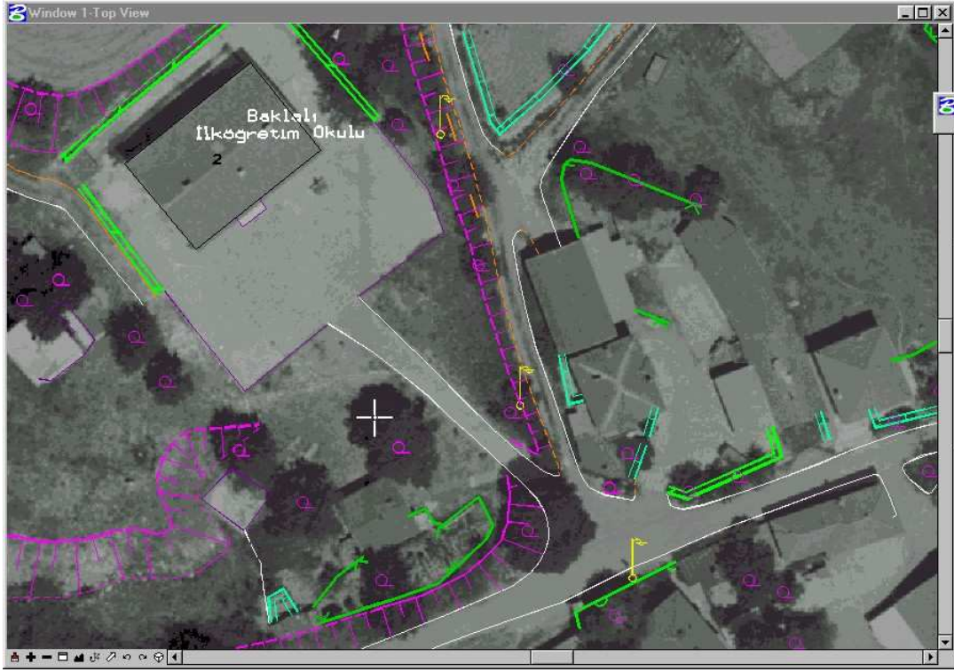
Şekil 10.10. Otomatik Korelasyon Metoduyla Oluşturulan SAM Kullanılarak Üretilen Ortofoto Haritanın Kartografik Detaylarla Uyumu.
