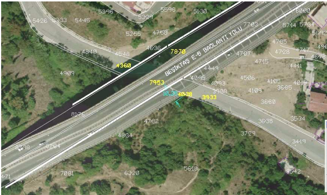
Şekil 10.6. Beşiktaş Ortaköy Viyadükünün True Ortofoto Öncesi Hali. SAM Hatasının Ortofoto Üzerindeki Etkisi.
