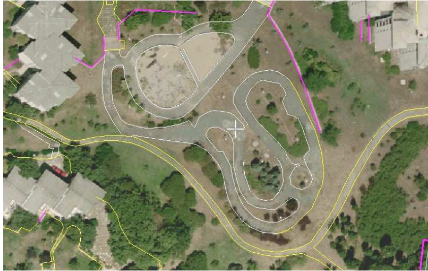
Şekil 10.5. Açık Arazide Oto korelasyon İle Üretilen SAM’in Kıymetlendirme Operatörünün Derlediği Sayısal Harita İle Uyumlu Olduğu ve Doğru Ortofoto Elde Edildiği Görülmektedir.
