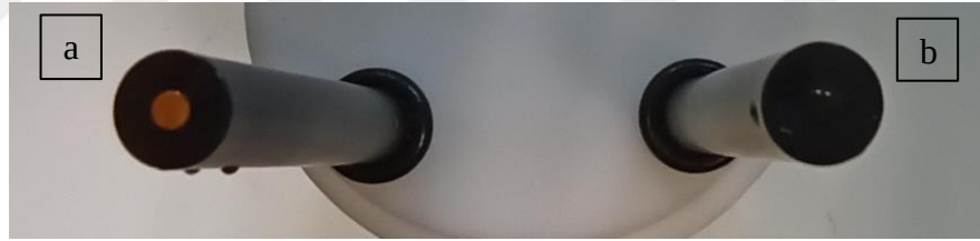
Şekil 6.16: Altın elektrotun; a) kaplama öncesi b) kaplama sonrası görüntüsü.
