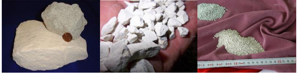
Şekil 5.3. Doğal Zeolit: Maden cevheri ve değişik tane boyutlu ürünler
