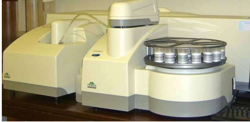
Şekil 7.20. Mastersizer 2000 partikül boyutu belirleme cihazı.
