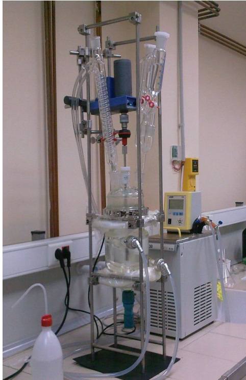
Şekil7.13. Emülsyon polimerizasyonu deney düzeneği.
