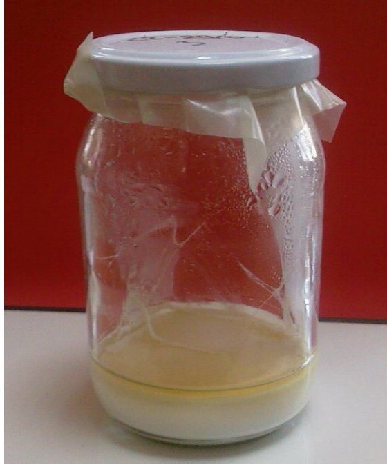
Şekil 7.21. Deney 9 termal stabilite testi sonunda yapısı bozulan lateks.
