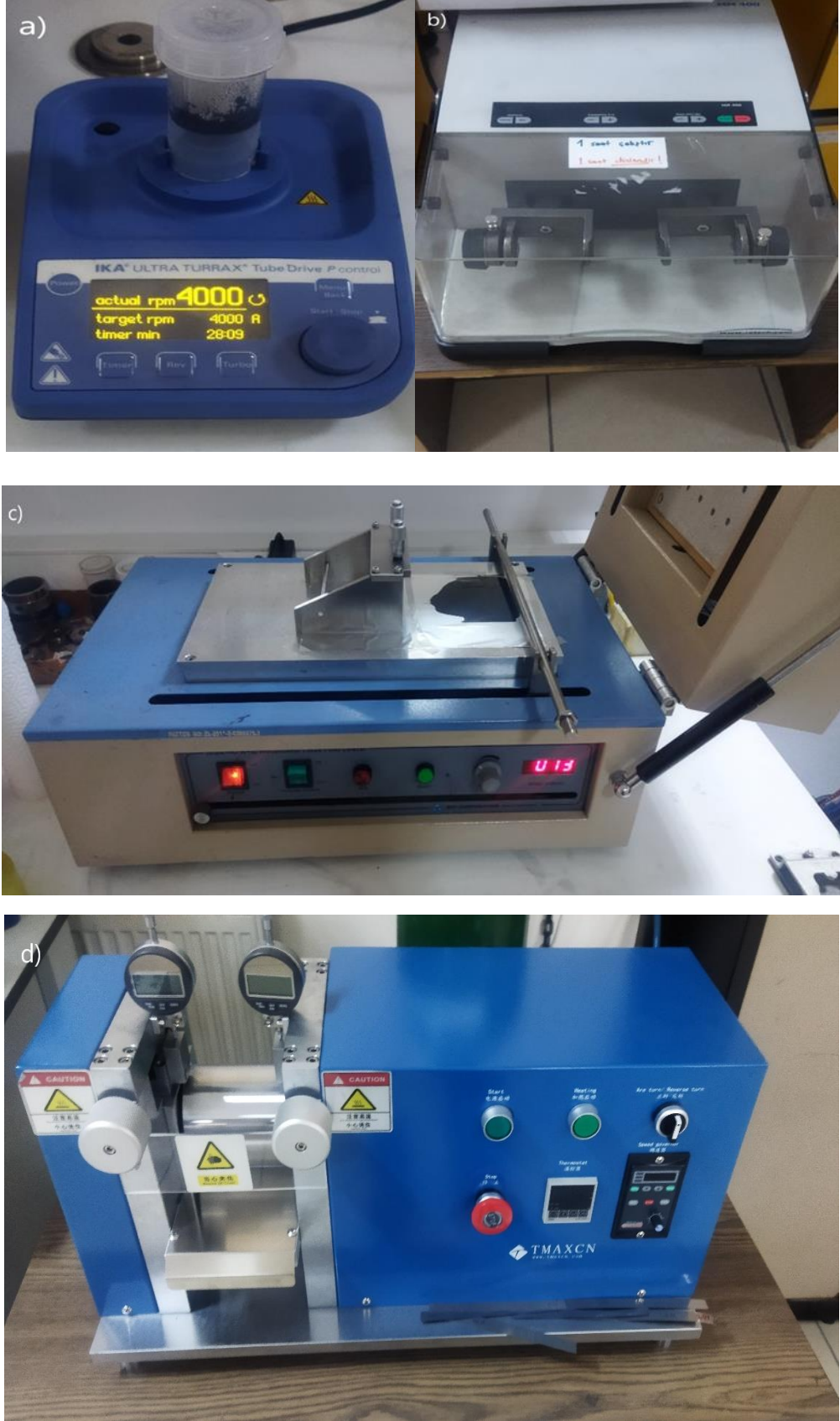
Şekil 4.1: GTÜ nanoteknoloji batarya araştırma laboratuvarı a) ultra turrax cihazı, b)bilyalı değirmen, c) otomatik film çekme cihazı (doctor blade), d) elektrot Yüzey haddeleme cihazı.
