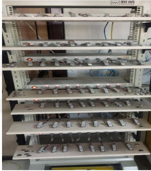
Şekil 4.4: GTÜ nanoteknoloji batarya araştırma laboratuvarı neware cihazı.
