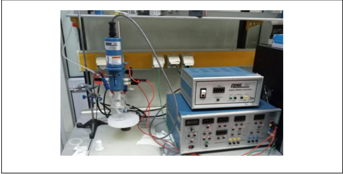
Şekil 4.2: Döngüsel voltametri deney seti.
