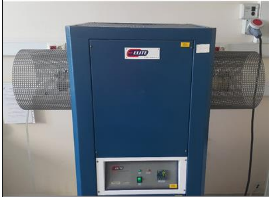
Şekil 5.4: Elite marka tüp tipi KOYH sinterleme fırını.
