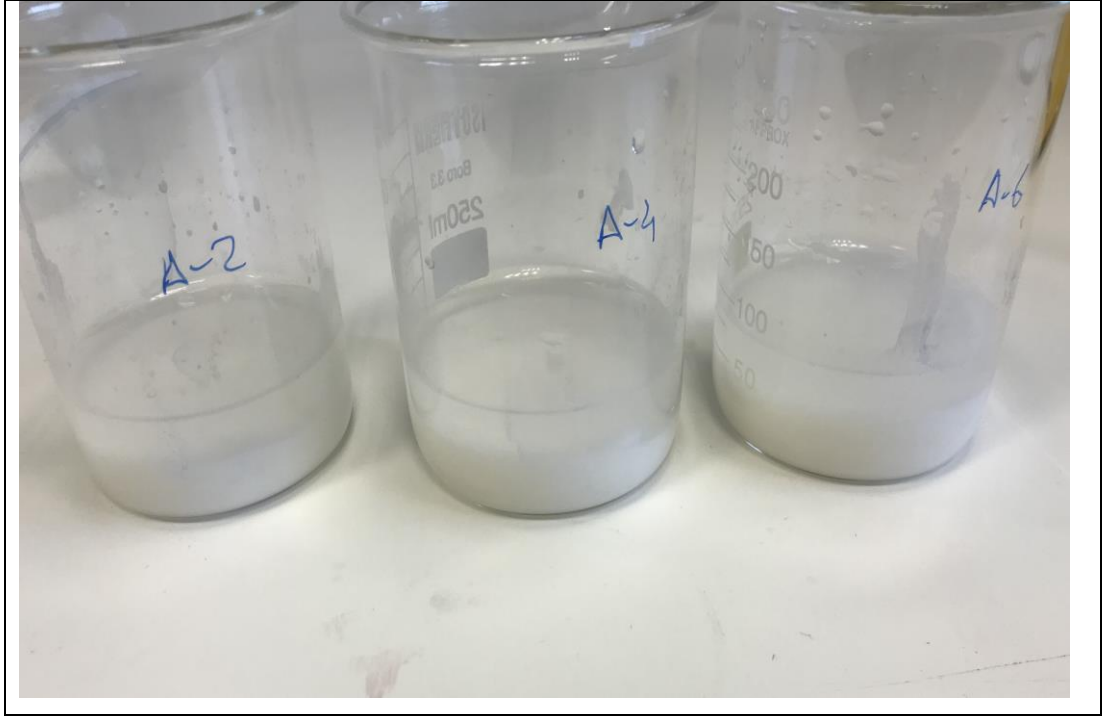
Şekil 4.12: Sırasıyla 5, 10 ve 20 g/L \text{Al}(\text{OH})_3 ilavesi yapılarak pH değeri 10.5'e yükseltlen numuneler.
