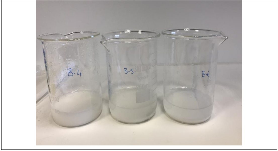
Şekil 4.3: 1:1 oranında sırasıyla pH 8, 8.5 ve 9 değerlerinde H_2O_2 çalışması.
