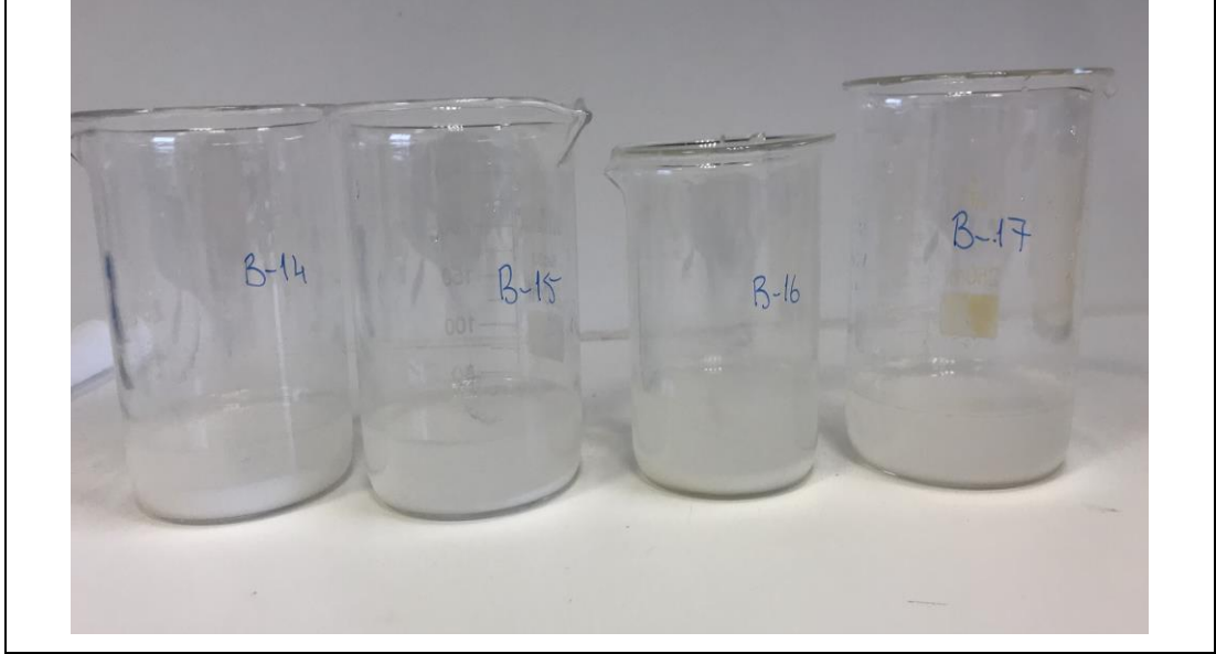
Şekil 4.6: 1:2 oranında sırasıyla orjinal pH, pH 8.5, pH 9 ve pH 10 değerlerinde H 2 O 2 ve BaCl 2 çalışması.
