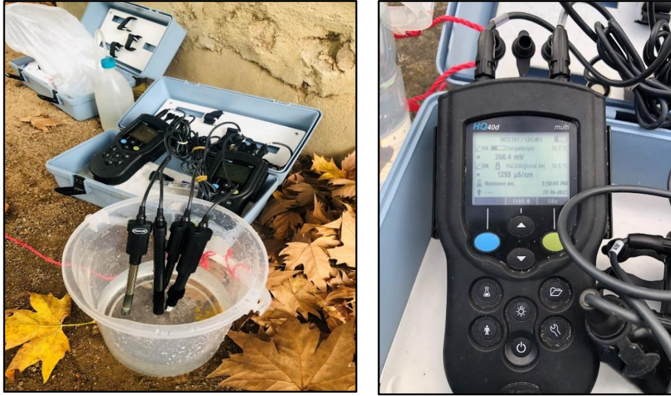
Şekil 3.3: Hach Lange-HQ40D çift kanallı multimetre.
