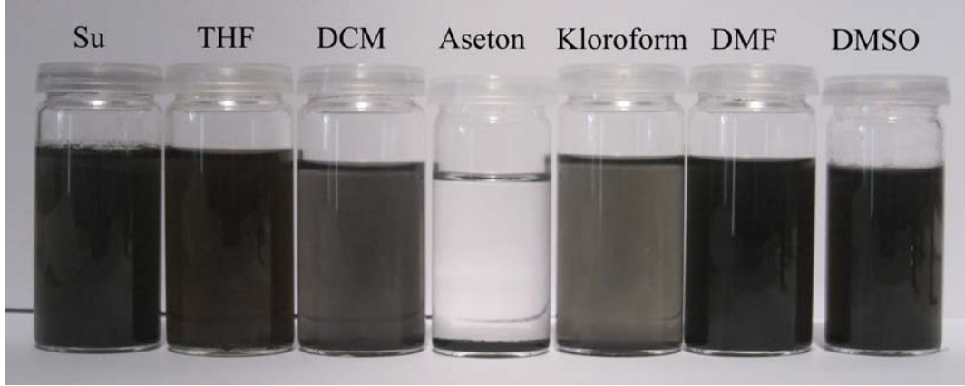
Şekil 5. 14. f -MWCNT/PZS 1.5 nanokompozitinin belirlenen çözücülerdeki çözünürlüğü.
