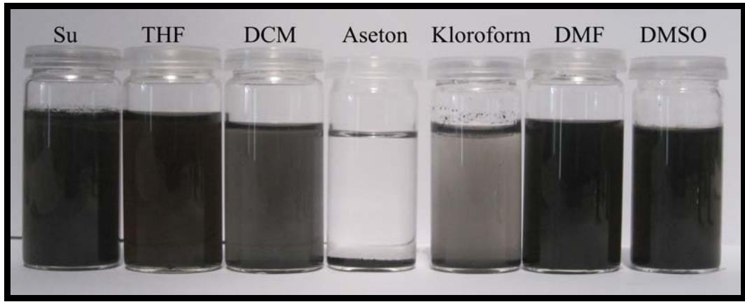
Şekil 5.18. f -MWCNT/PDK 1:5 nanokompozitinin belirlenen çözücülerdeki çözünürlüğü.
