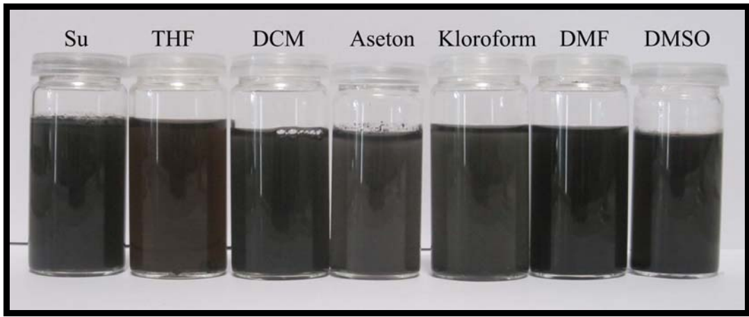
Şekil 5.22. f -MWCNT/PEG 1:5 nanokompozitinin belirlenen çözücülerdeki çözünürlükleri.
