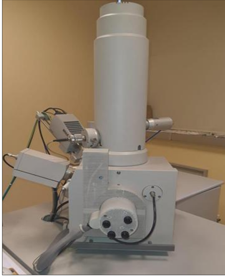
Şekil 5.10: FEI (PHILIPS) XL30 SFEG taramalı elektron mikroskobu [113].
