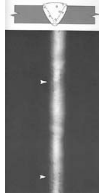
Şekil 3.1 Gözenek ve Radyografik Fotoğrafı [www.tafensw.edu.au, 2007]
