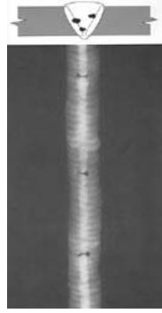
Şekil 3.2 Kalıntılar ve Radyografik Fotoğrafı [www.tafensw.edu.au, 2007]
