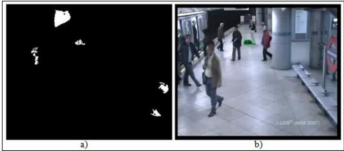
Şekil 4.6: a) Aday Şüpheli Nesne Maskesi, b) Tespit Edilen Şüpheli Nesne.
