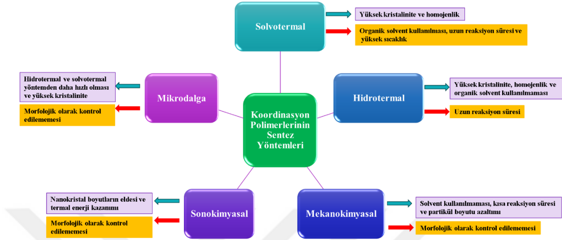
Şekil 2.6: Yaygın olarak kullanılan koordinasyon polimerlerinin sentez yöntemlerini gösteren şema [23].
