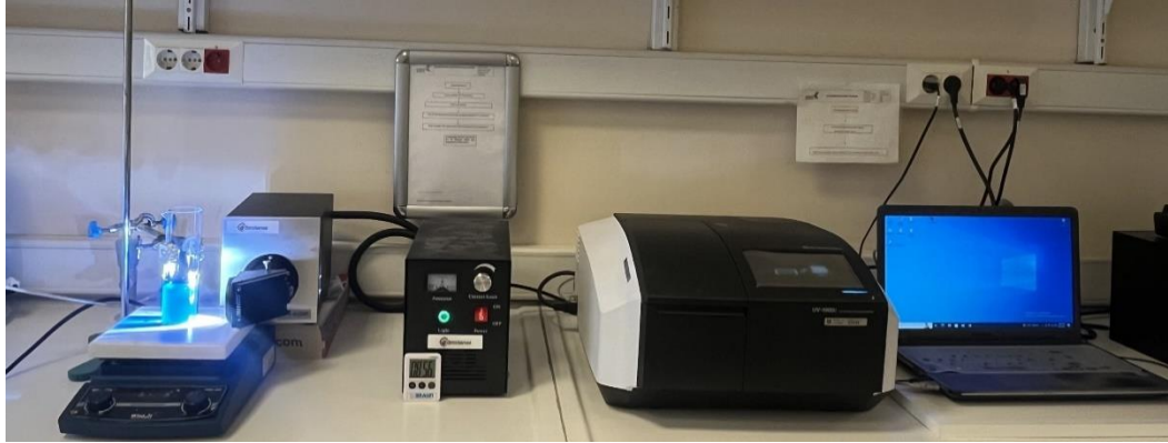
Şekil 6.3: Görünür ışık aydınlatması için kullanılan fotokataliz çalışma düzeneği.
