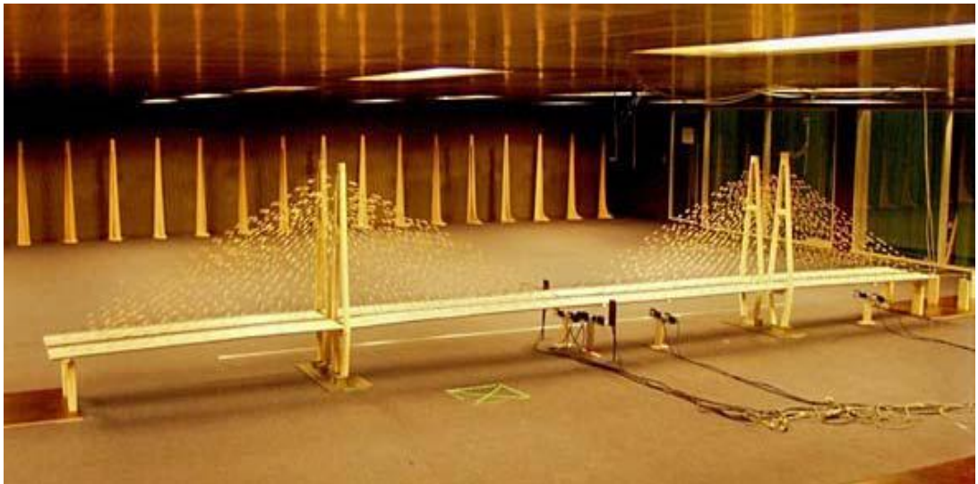
Şekil 2.32. Rüzgar Tüneli Testleri İçin Ölçekli Kablolu Köprü Modeli [ Boduroğlu, 2007].
