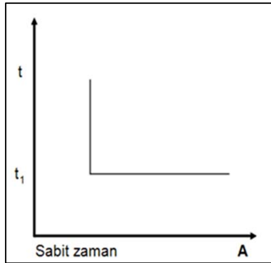
Şekil 6.2: Sabit zamanlı röle karakteristiği.
