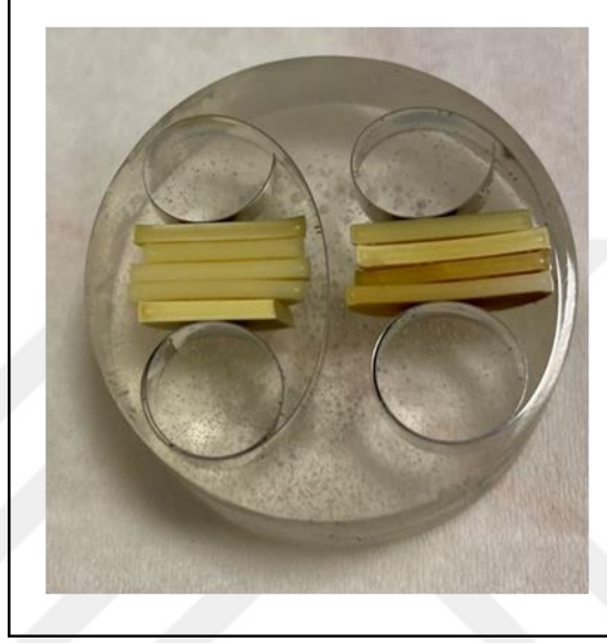
Şekil 5.1: SEM analizi için epoksi kalıpta hazırlanan numuneler.
