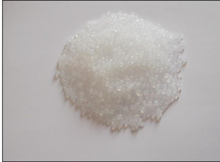
Şekil 4.33: PE malzemesinin enjeksiyon öncesi granül görüntüsü.
