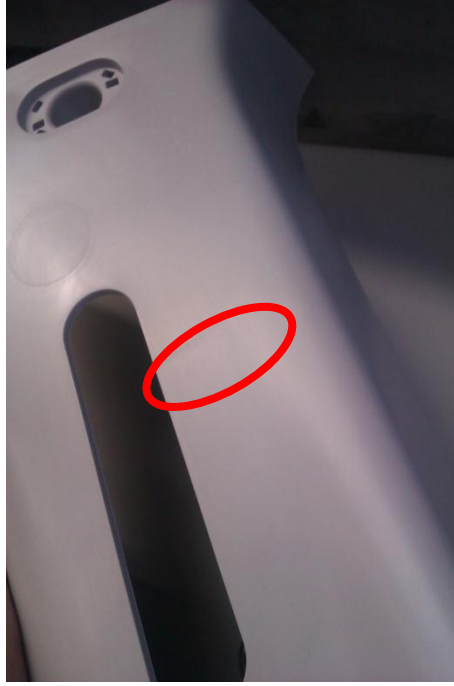
Şekil 3.4: İki akışın birlikte ilerlemesiyle oluşan birleşme izi görüntüsü.
