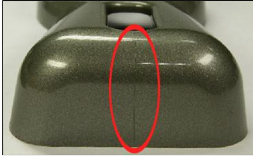
Şekil 3.2: İki karşı akışın birleşimiyle oluşan birleşme izi görüntüsü.
