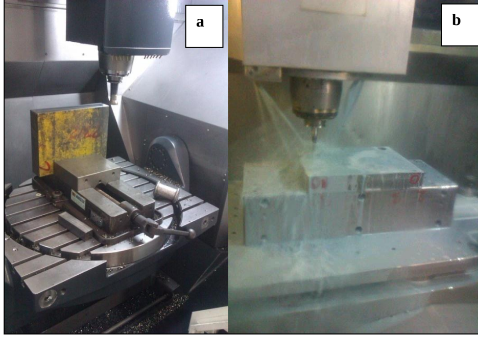
Şekil 1.7: Çeliklerin CNC tezgâhlarında bloklama ve işleme aşamaları. a) Çeliklerin CNC tezgâhlarında bloklama işlemi, b) Çeliklerin CNC tezgâhlarında işleme aşaması.
