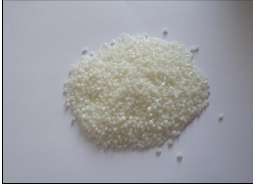
Şekil 4.13: ABS malzemesinin enjeksiyon öncesi granül görüntüsü.
