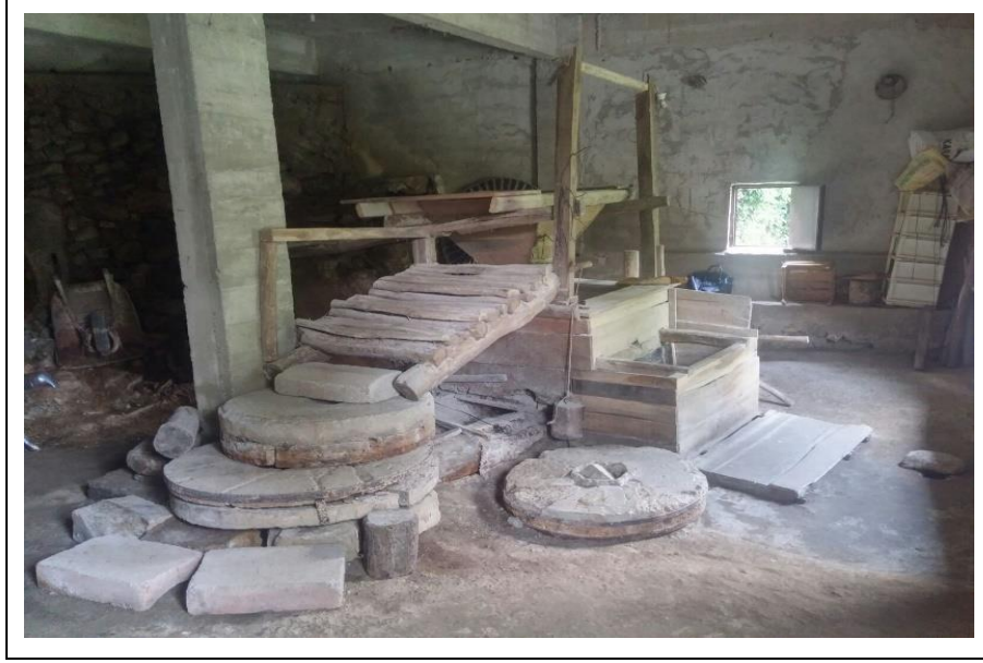
Şekil 5.5: Taşoluk Değirmeni mekanizması.
