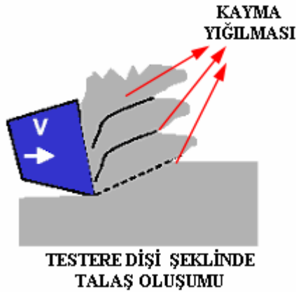
Şekil 2-13. Testere dişi şeklinde talaş oluşumu.
