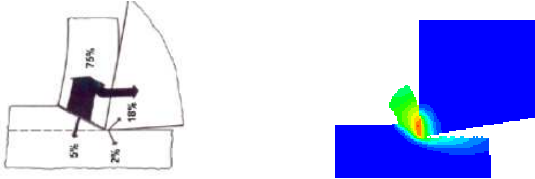
Şekil 2-3. Metal kesmede sıcaklık dağılımı.
