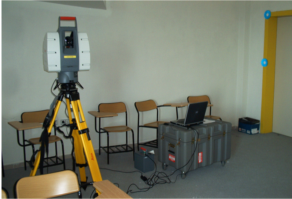
Şekil-2.2. Uygulamada Kullanılan Yersel Lazer Tarayıcı ve Bileşenleri
