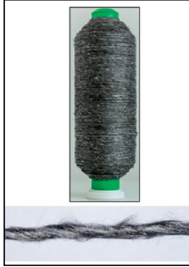
Şekil 3.3: Kelebekli eğirme yöntemi ile üretilen hibrit iplik ve bobin.
