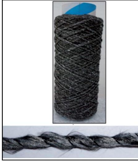
Şekil 3.2: Sarımlı eğirme yöntemi ile üretilmiş hibrit iplik ve bobin.
