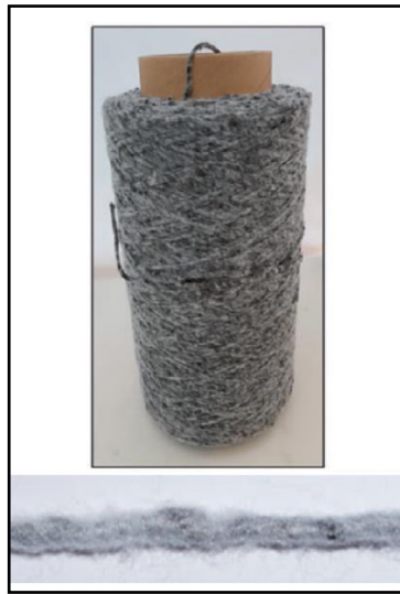
Şekil 3.4: Sürtünmeli eğirme yöntemi ile üretilen hibrit iplik ve bobin.
