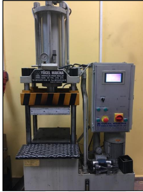
Şekil 4.9: Kompozit laminat üretiminde kullanılan sıcak pres.
