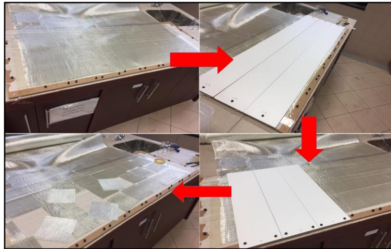
Şekil 4.3: Cam elyaf kumaş ve kumaş kesim mastarı.
