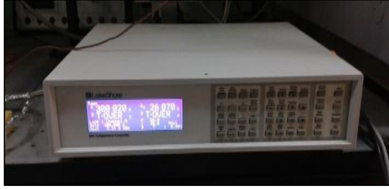
Şekil 3.4: Sıcaklık kontrolü için kullanılan Lakeshore 340 sıcaklık kontrol cihazı.
