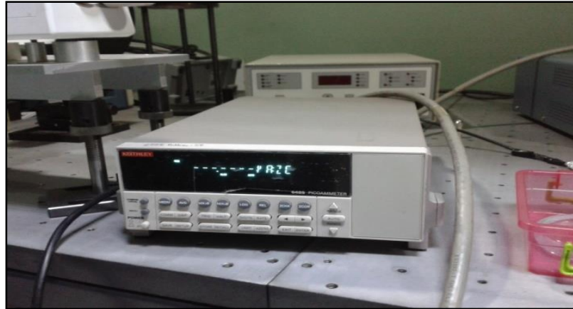
Şekil 3.6: Akım ölçümleri için kullanılan Keithley 6485 pikoampermetre.
