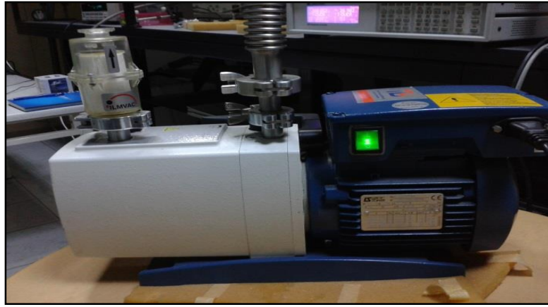
Şekil 3.5: Ölçümlerde kullanılan Ilmvac vakum pompası.
