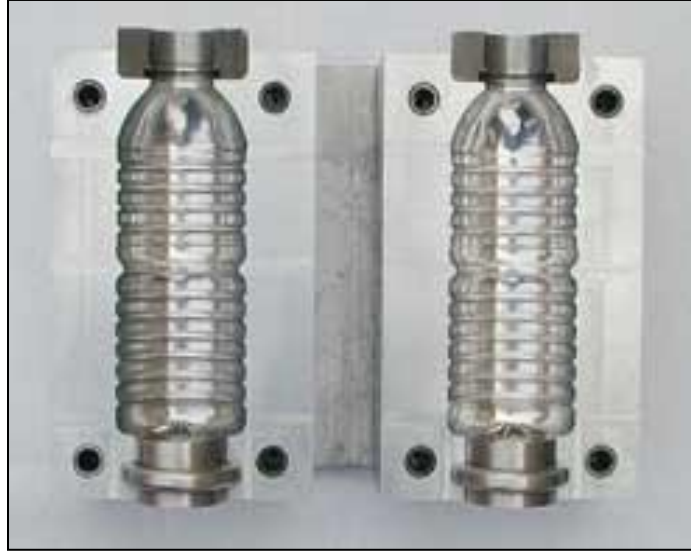
Şekil 4.19. Hava üflemeli döküm yönteminde kullanılan şekillendirme kalıbı [14].
