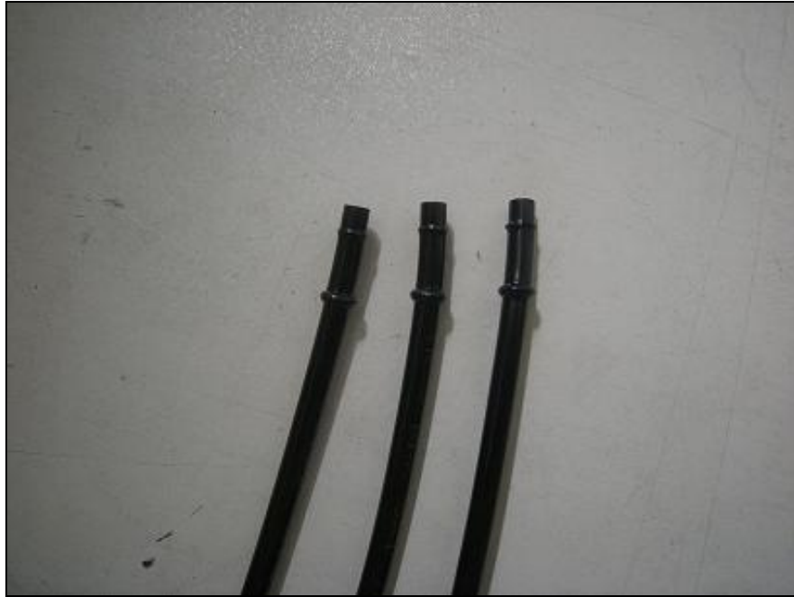
Şekil 5.1. Boğum şişirilmiş bir PA boru
