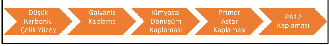
Şekil 2.1: Numune üretim aşamaları.
