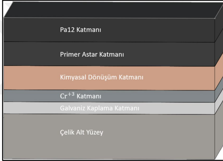
Şekil 3.1: Numune kaplama katmanları.
