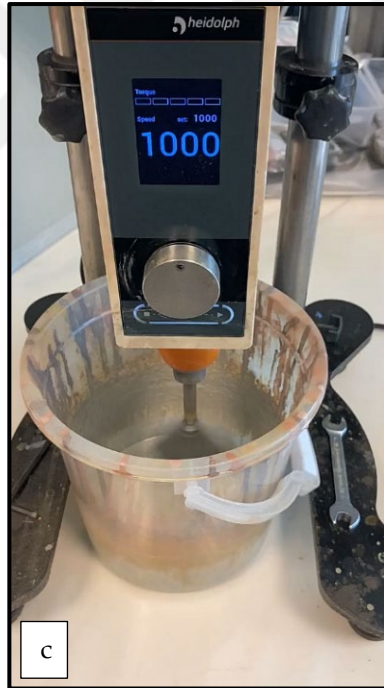
Şekil 2.5: (a) Grafenin astar içerisinde karıştırıcı yardımı ile dağıtılması, (b) Astar kaplama işlemi, (c) Fazla astarın yüzeyden arındırılması, (d) Kaplanan numunelerin fırında kurutulması.
