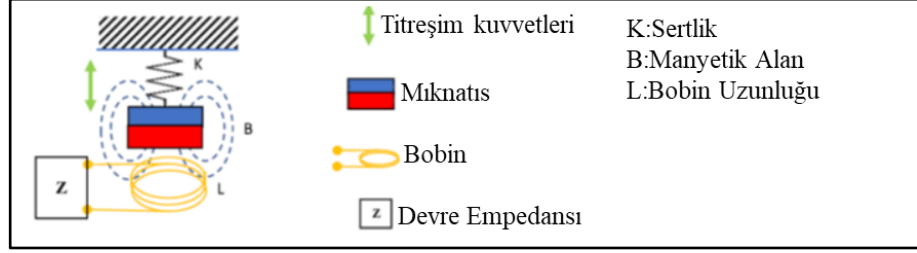
Şekil 2.9: Basit elektromanyetik EH’nin şematik gösterimi.
