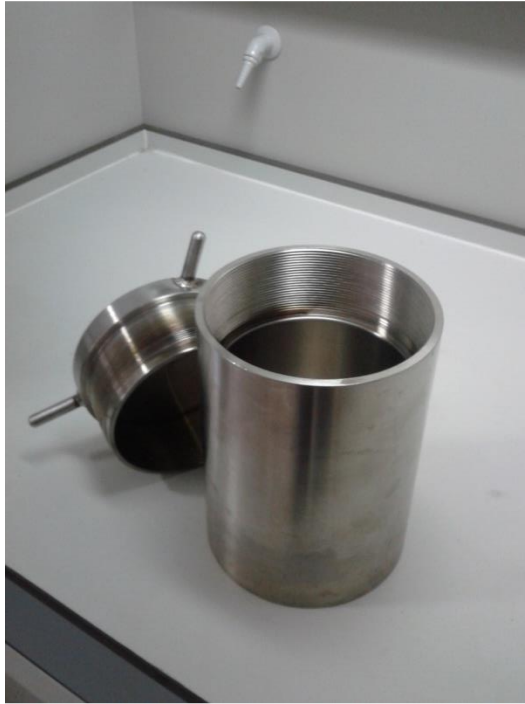
Şekil 3.1: Sentezlerde kullanılan reaktör.
