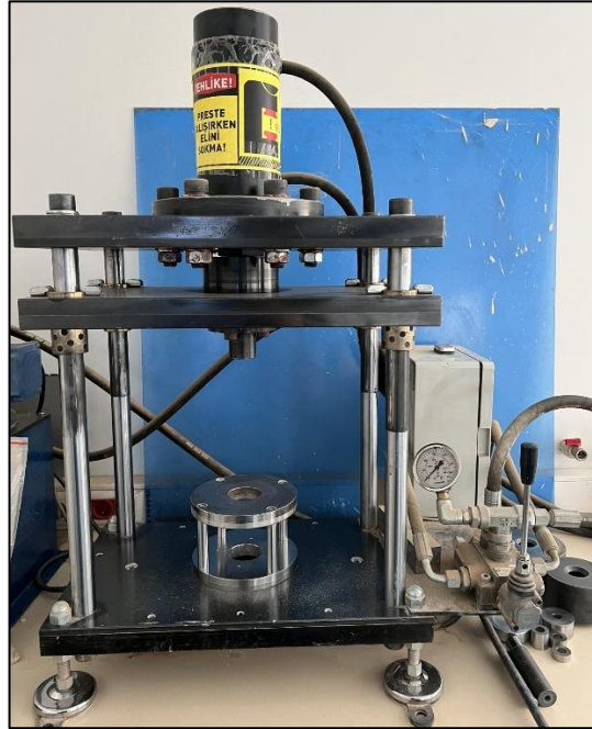
Şekil 4.4: Piezoelektrik seramik malzeme üretiminde kullanılan pres.
