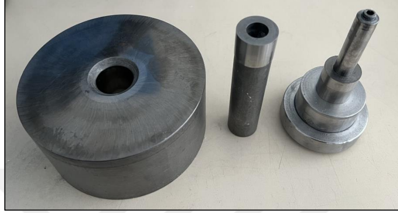
Şekil 4.3: Piezoelektrik seramik malzeme üretiminde kullanılan metal kalıp.
