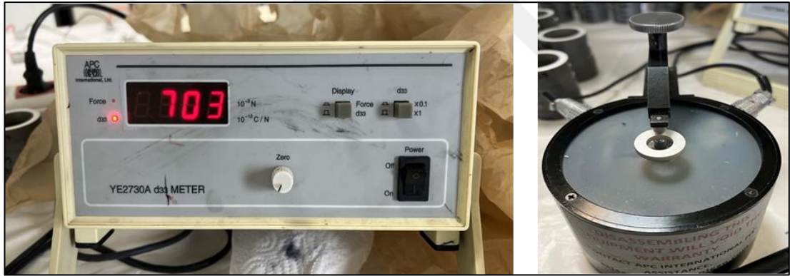
Şekil 4.10: d_{33} ölçüm düzeneği.
