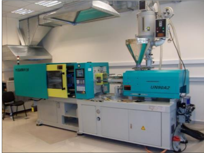
Şekil 3.2: Plastik enjeksiyon makinası.
