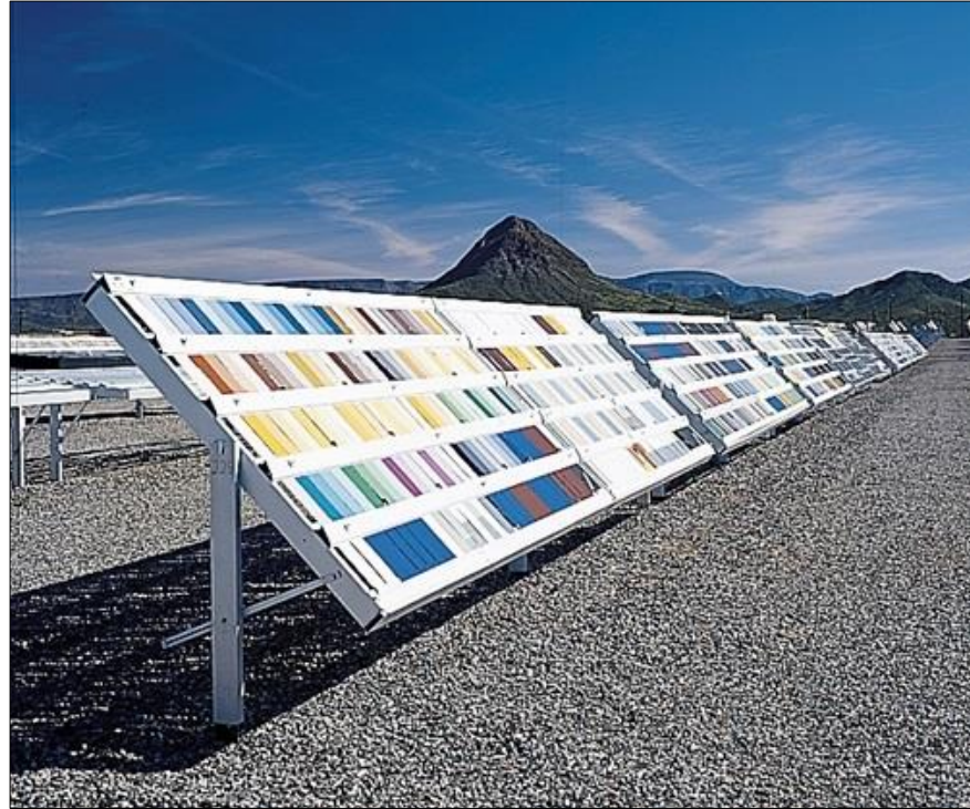
Şekil 1.1: Doğal yaşlandırma numune rafları.
