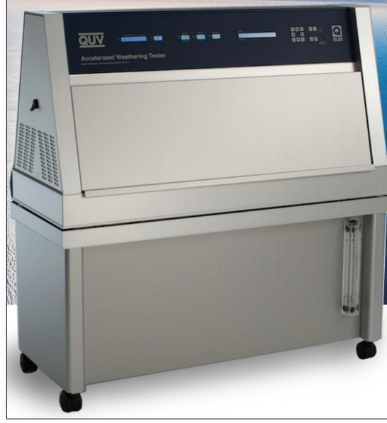
Şekil 1.2: Hızlandırılmış yaşlandırma cihazı.
