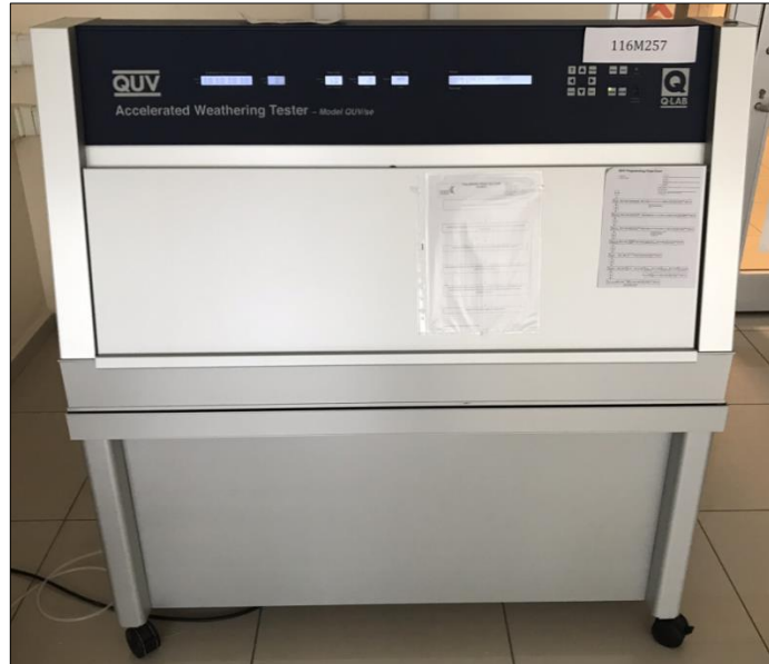
Şekil 3.7: Hızlandırılmış yaşlandırma cihazı.
