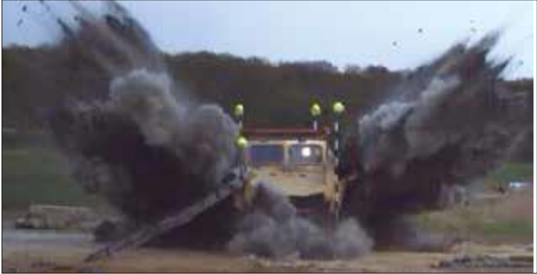
Şekil 3.7 SPV 400 Supacat Mayın Patlamasına Maruz Kalması
