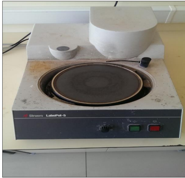
Şekil 3.12: Zımparalama ve parlatma cihazı.
