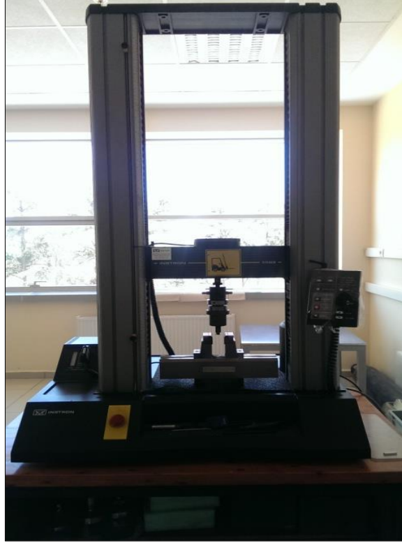
Şekil 3.9: Üç nokta eğme tekniği ile mukavemet değerlerinin belirlenmesinde kullanılan yük yükleme cihazı.
