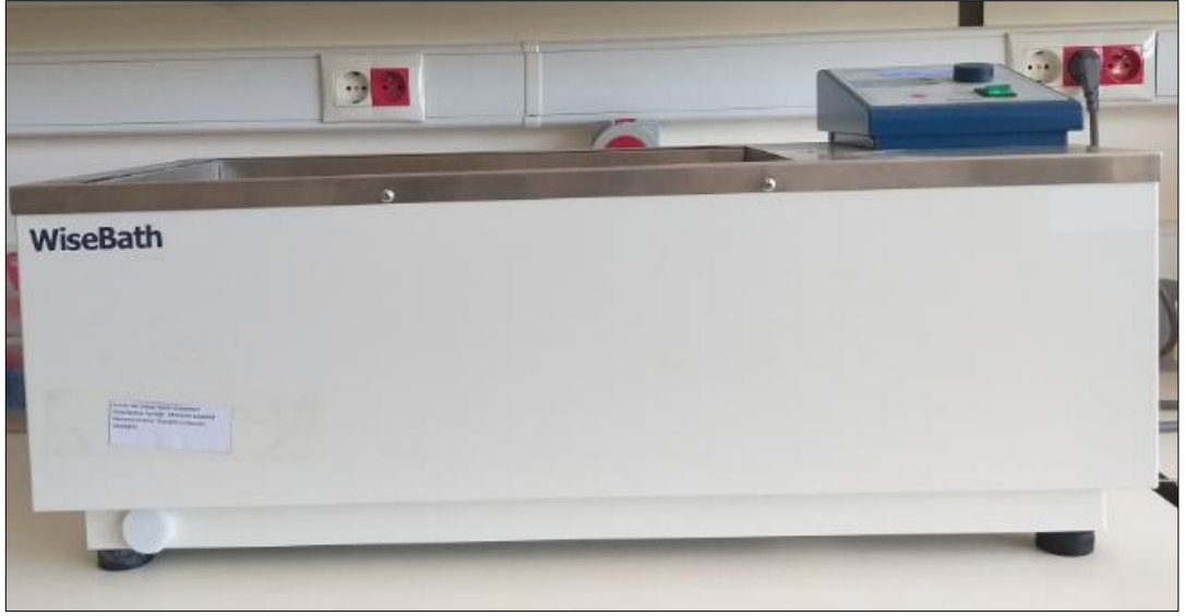
Şekil 3.14: Titreşimli su banyosu.
