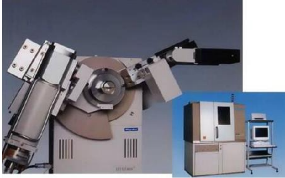
Şekil 3.11: Numunelerde gelişen kristal fazların tayininde kullanılan x-ışını kırınım cihazı.
