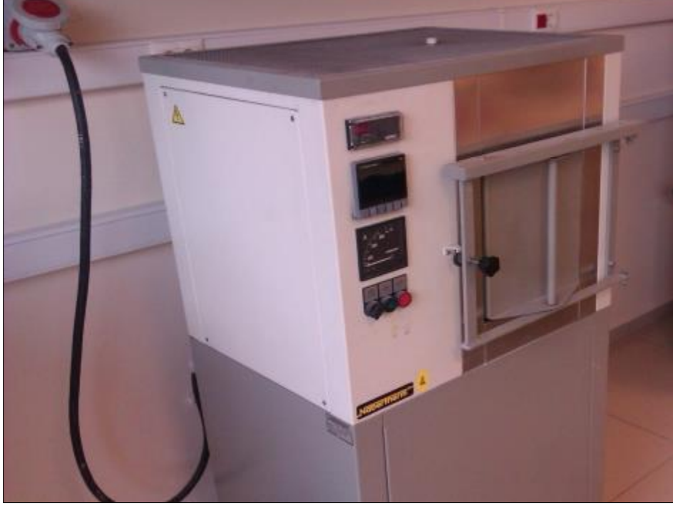
Şekil 3.6: Numunelerin sinterlenmesi için kullanılan elektrik ısıtmalı kutu fırın.
