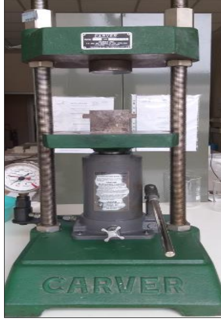
Şekil 3.5: Numunelerin şekillendirilmesinde kullanılan manuel hidrolik pres.
