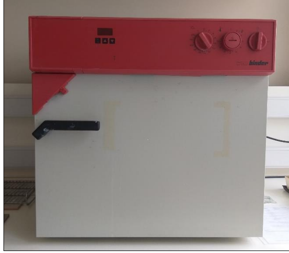
Şekil 3.3: Sulu ortamda öğütülen karışımların kurutulmasında kullanılan etüv.
