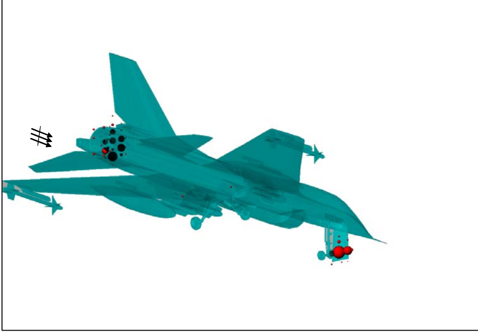
Şekil 6.16 Uçak modelinin 'sinc' aradeğerleyicisi kullanılarak çekilen saçılma merkezleri.
