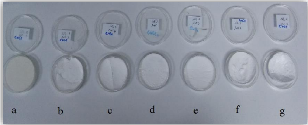
Şekil 3.4: İpek Fibroin (LiBr) PVA Sünger Kompozit a) PVA/İpek: 0/10, b) PVA/İpek: 3/7, c) PVA/İpek: 4/6, d) PVA/İpek: 5/5, e) PVA/İpek: 6/4, f) PVA/İpek: 7/3, g) PVA/İpek: 10/0.
