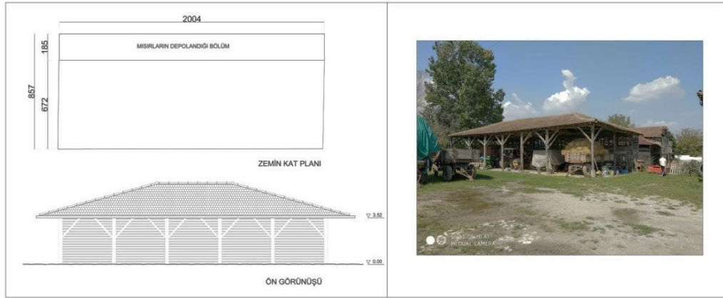
Şekil 5.10: Ahşap karkas taşıyıcı sistemi olan kurluk örneği.
