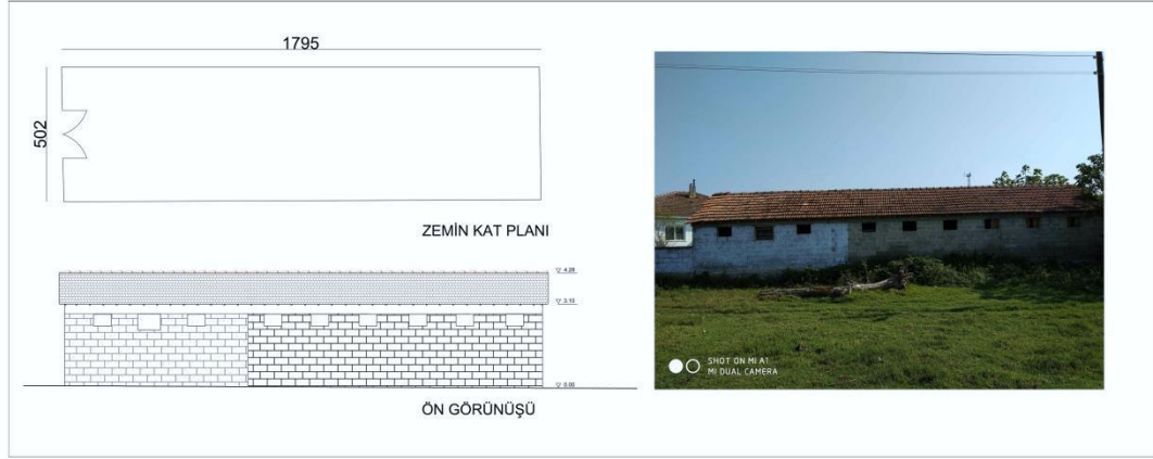
Şekil 5.11: Yığma taşıyıcı sistemi olan ahır + kuruluk örneği.
