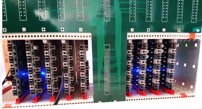
Şekil 5.6: FPGA kontrol ünitesi ve fiber optik kartlar.
