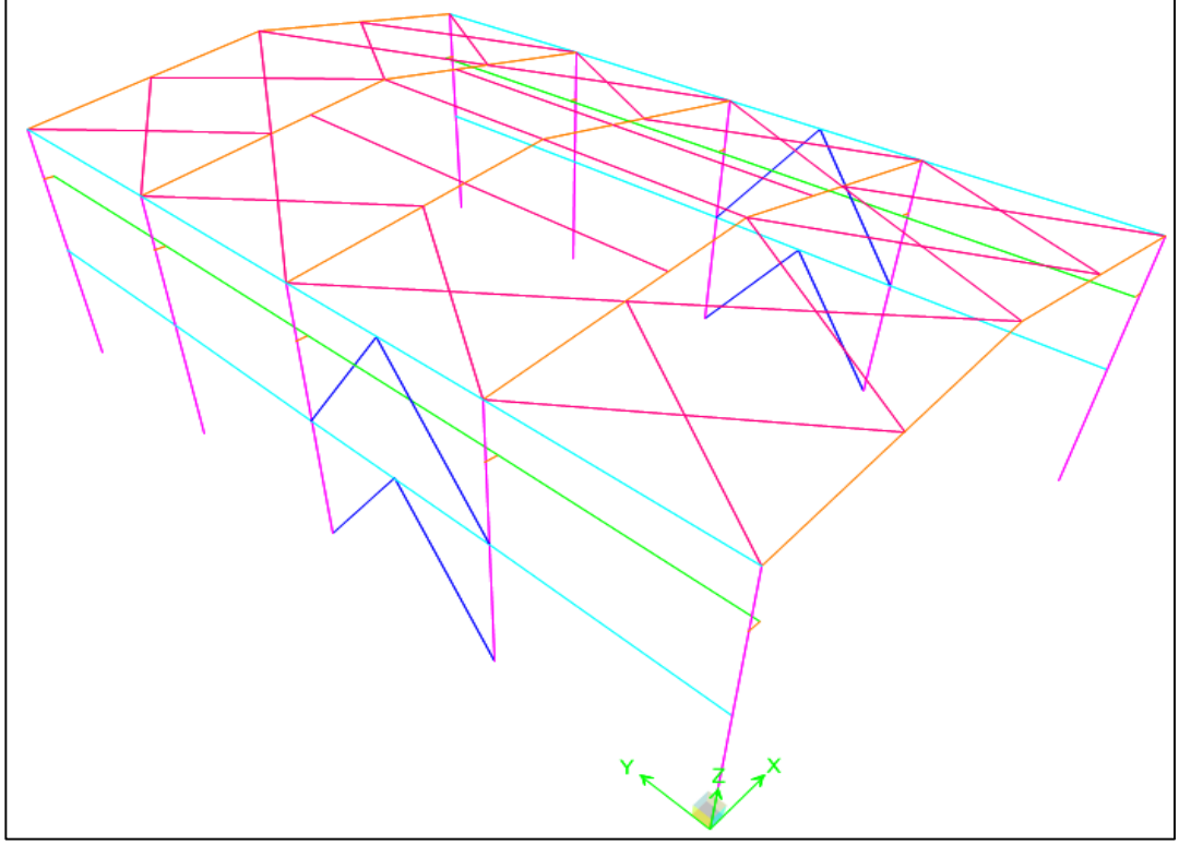
Şekil 4.1: Endüstri yapısının üç boyutlu çerçeve eleman görünümü.
