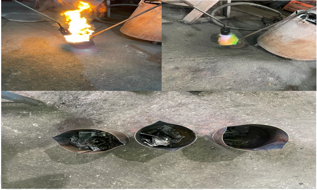
Şekil 3.6: (a) Isıl işlem anı-1,(b) Isıl işlem anı-2 ve (c) Isıl işlem sonrası.
