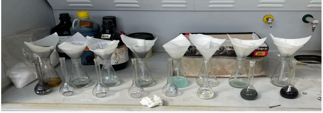
Şekil 3.11: Numunelerin kaba filtreden süzme işlemi.
