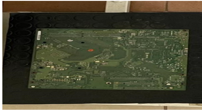
Şekil 3.4: Bileşenlerinden ayrılmış anakart numunesi.
