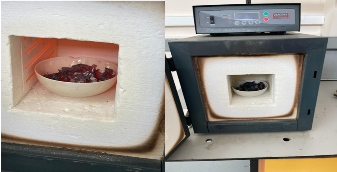
Şekil 3.7: Isıl işleme tabi tutulan anakart numuneleri.
